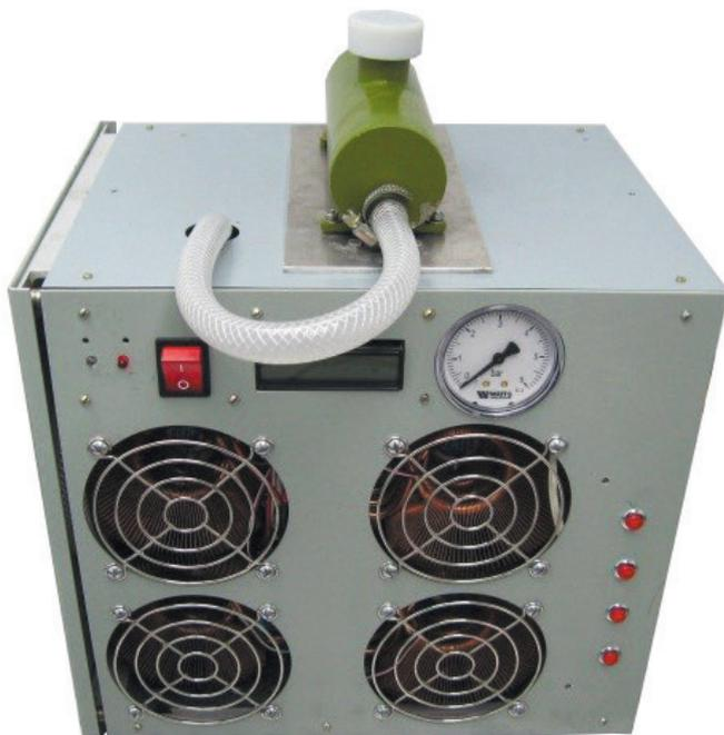
Система термостабилизации СО-300 обеспечивает поддержание рабочей температуры теплоносителя в необходимом температурном диапазоне. Максимальная отводимая тепловая мощность 300 Вт при температуре теплоносителя не ниже температуры воздуха.
